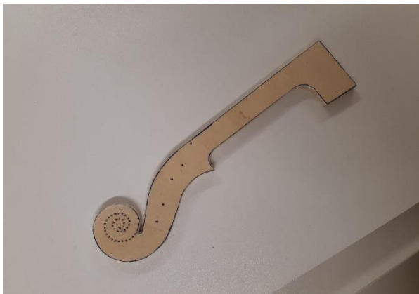
Slika 6: Šablona vratu in polža (lasten vir)
