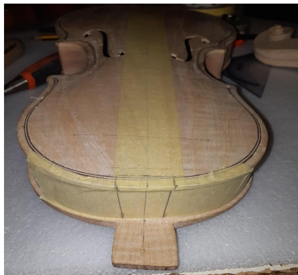
Slika 38: Zarisan utor (lasten vir)
