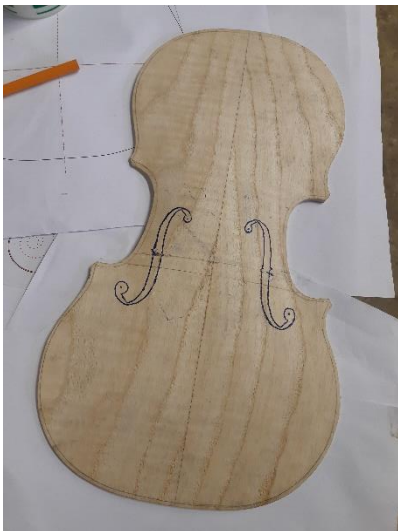
Slika 20: Zarisane f-odprtine (lasten vir)
