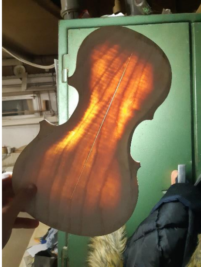
Slika 19: Prikaz debeline pokrova (lasten vir)
