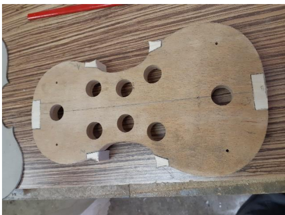
Slika 7: Šablona oboda z nosilci (lasten vir)
