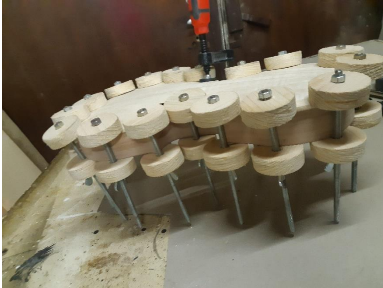
Slika 28: Lepljenje pokrova na obod (lasten vir)
