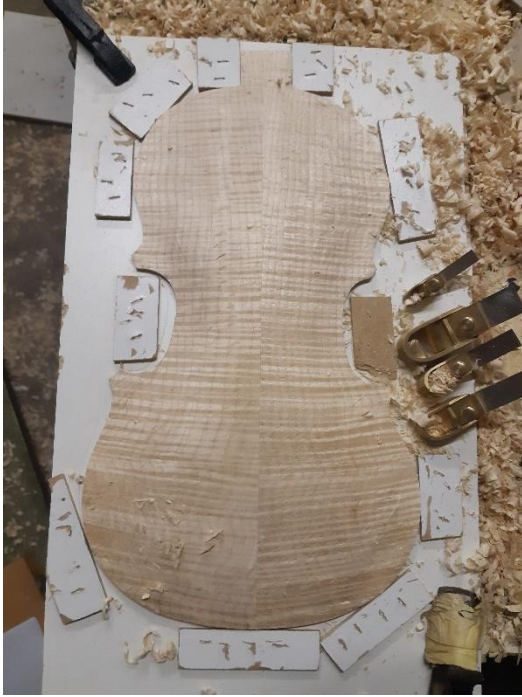
Slika 25: Površinsko končan hrbet (lasten vir)
