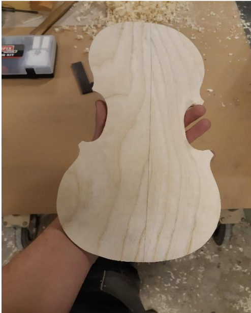
Slika 17: Površinsko obdelan pokrov( lasten vir)
