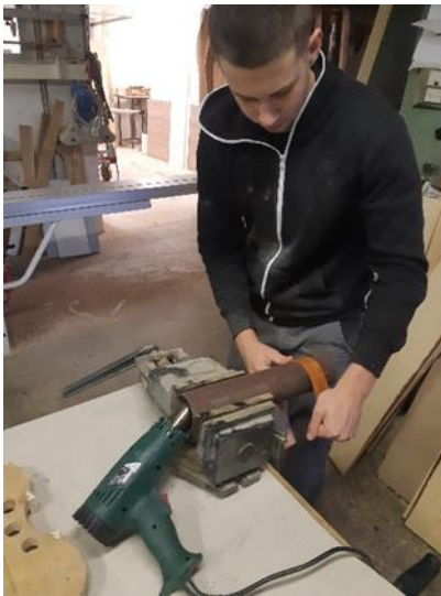
Slika 10: Prikaz krivljenja (lasten vir)
