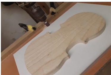
Slika 14: Izrezan pokrov (lasten vir)
