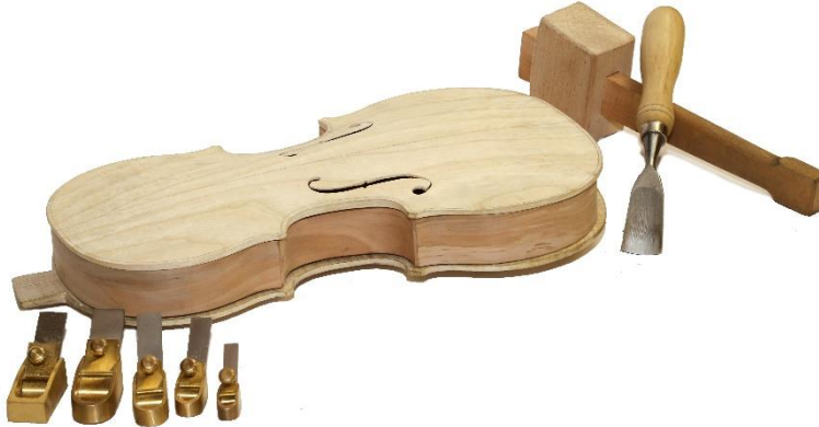
Slika 27: Prikaz delov in orodja za izdelavo trupa (lasten vir)
