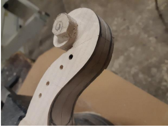
Slika 34: Groba oblika polža (lasten vir)
