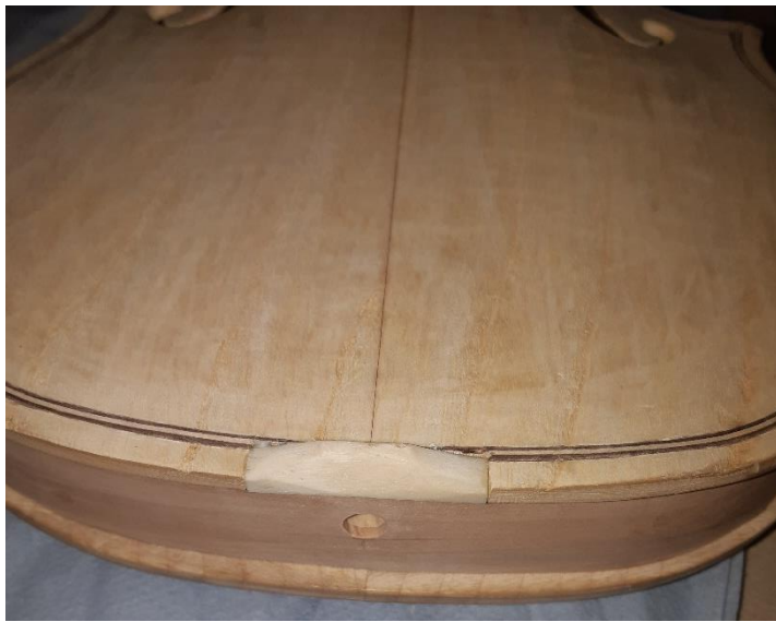
Slika 45: Vstavljena kost od spredaj (lasten vir)
