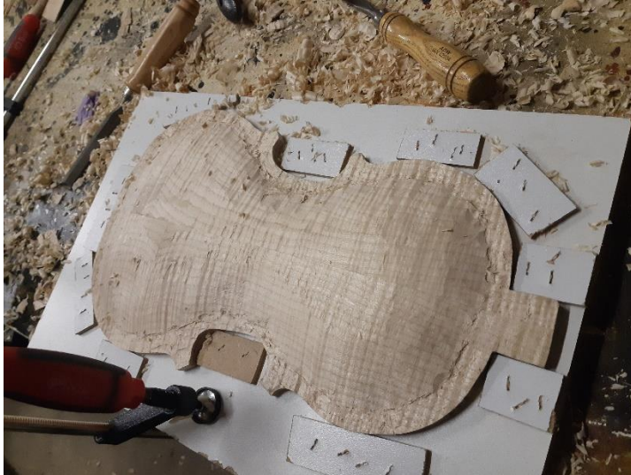
Slika 24: Groba oblika dna (lasten vir)
