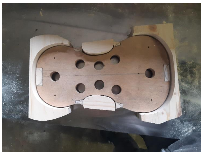
Slika 9: Šablone za lepljenje (lasten vir)
