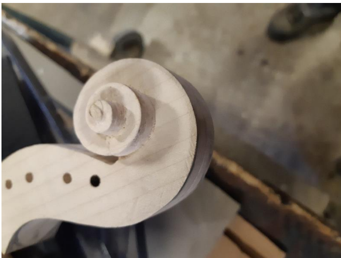
Slika 35: Prikaz spirale polža s kanali (lasten vir)
