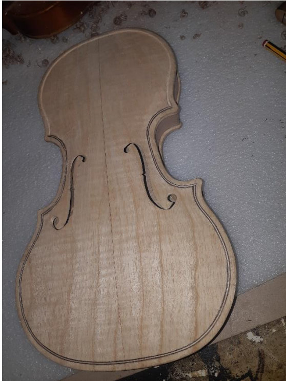
Slika 32: Vstavljeno polnilo na pokrovu (lasten vir)
