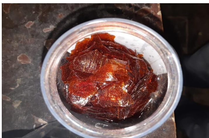
Slika 4: Neraztopljen šelak (lasten vir)
