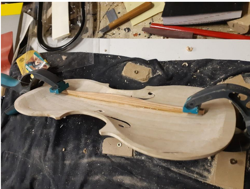
Slika 22: Zalepljen bas (lasten vir)
