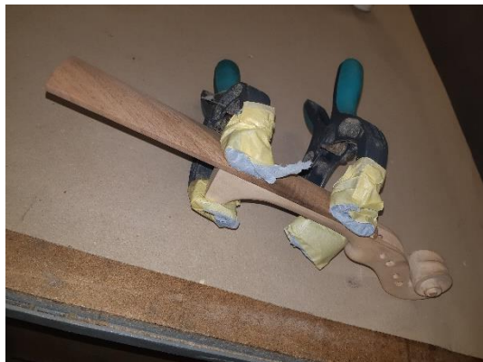
Slika 37: Umerjanje ubiralke (lasten vir)
