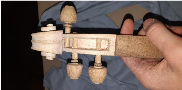
Slika 46: Grobo obdelani ročaji vijakov (lasten vir)
