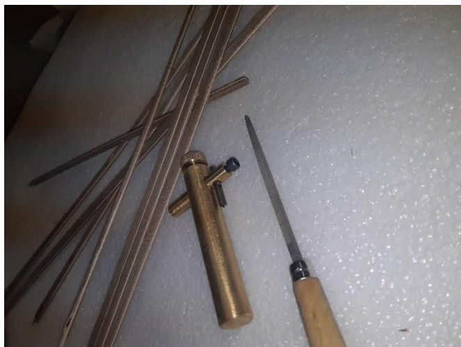
Slika 30: Prikaz rezil za izdelavo utora (lasten vir)
