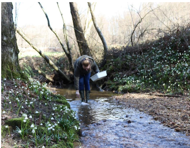
Slika 17: Nabiranje vzorcev nevretenčarjev z metodo »kick sampling« (vir: Gregorc, T., 2020).
