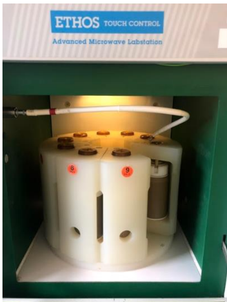
SLIKA 9: NAMEŠČENI KOLUTI V MIKROVALOVNEM SISTEMU (OSEBNI ARHIV)
