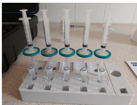
Slika 16: Hitri test za preverjanje prisotnosti fekalnih bakterij v vodi. (Foto: Vesna Fabjan, 28. 10. 2019.)
