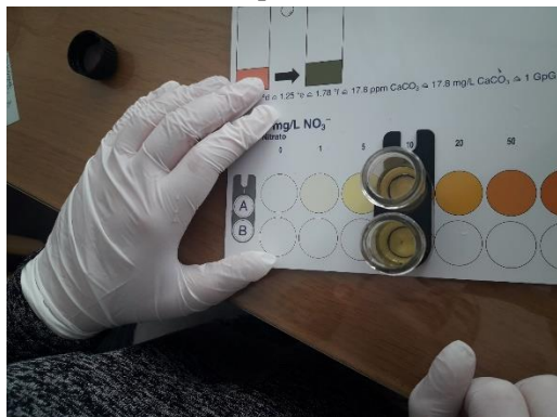
Slika 13: Analiza vode za določanje vsebnosti nitratov v vodi. (Foto: Špela Vraničar, 2. 2. 2019.)
