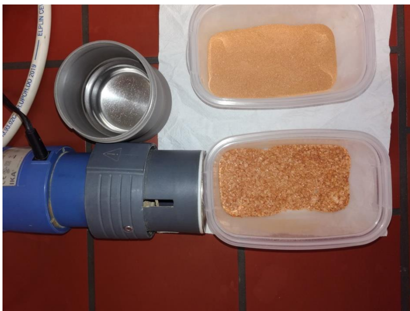
Slika 6: Čebulni listi pred (posodica spodaj) in po mletju (posodica zgoraj) s krogličnim mlinom
