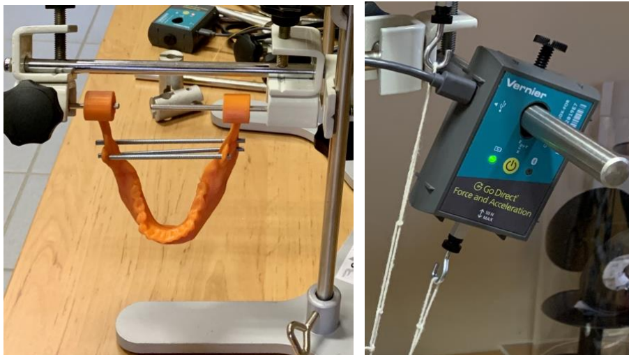
Slika 5: (levo) Replika človeške čeljusti v merilnem sistemu. Slika 6: (desno) Merilnik sile.
