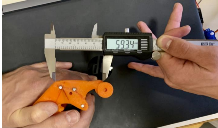
Slika 4: Meritev razdalje med dvema točkama s kljunastim merilom.
