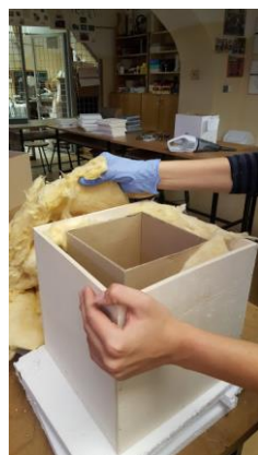
Slika 9: Vzorec 40 mm steklene volne (Vir: lasten)
