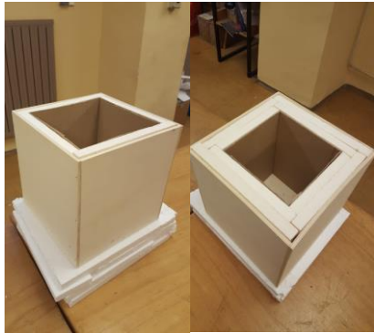
Slika 4: Vzorca 20 mm in 40 mm stirodurja (Vir: lasten)
