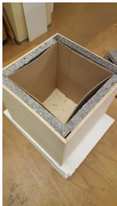
Slika 6: Vzorec 20 mm grafitnega stiropora (Vir: lasten)
