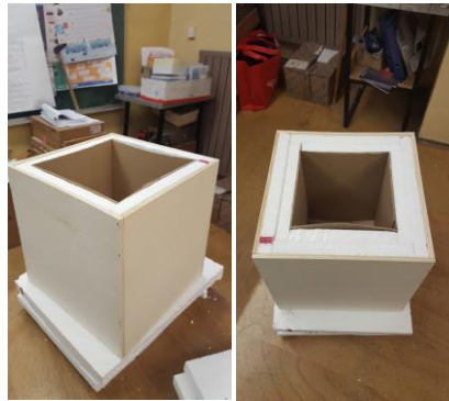
Slika 5: Vzorca 20 mm in 40 mm stiropora (Vir: lasten)
