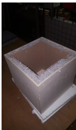
Slika 8: Vzorec 20 mm celuloze (Vir: lasten)
