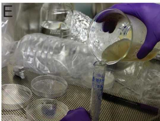
Slika 2.2: Slikovni prikaz postopkov dela v laboratoriju. A) Tehtanje agarja z analitsko tehtnico, B) Dodajanje vode k agarju z merilnim valjem, C) Tehtanje glicerola z analitsko tehtnico, D) Mešanje in segrevanje z mešalnim grelnikom, E) Odmerjanje raztopine z merilnim valjem, F) Vlivanje raztopine v petrijevke pod laminarijem.
