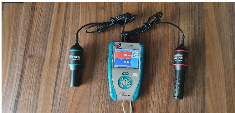
Slika 4: Merilni instrument Vernier LabQuest in tipali za merjenje količine ogljikovega dioksida in kisika (Vir: lasten)
