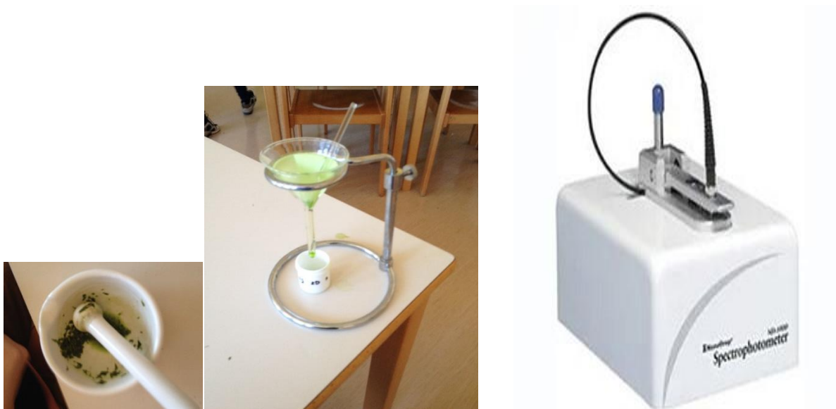
Slika 14: Postopek ekstrakcije klorofila in spektrofotometer NanoDrop
