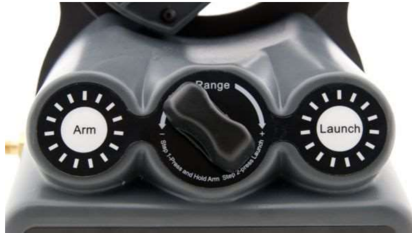
Slika 7: Gumba za izstrelitev (Arm in Launch) in vrtljivi gumb (Range) za reguliranje hitrosti, vir slike [3]
