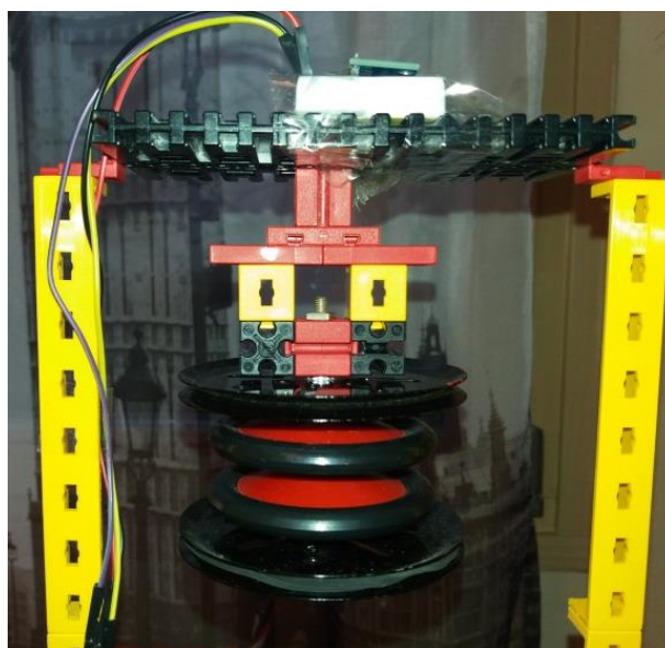
Slika 4.6: Slika pritrjenega masnega blažilnika na stavbo brez vrtilišča in podaljškov
