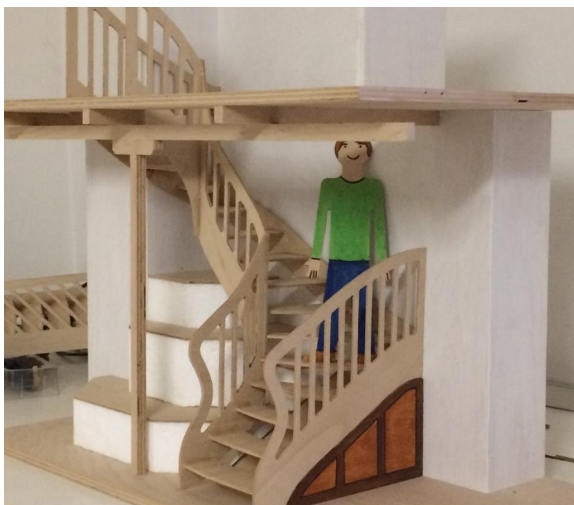
Slika 40: Prikaz ideje izkoristka prostora stopnic v obliki črke U. (Avtorica: Karla Rap, Laporje, 20. 2. 2020)
