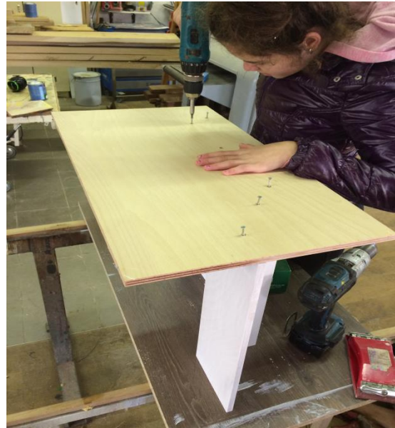
Slika 26: Sestavljanje in vijačenje tal ter sten. (Avtorica: Karla Rap, Laporje, 28. 12. 2019)
