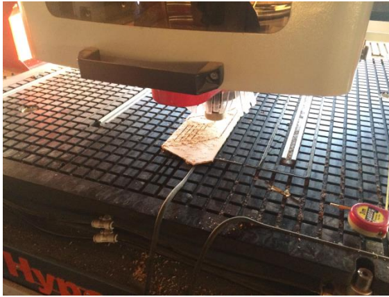
Slika 31: CNC stroj za obdelavo lesa obdeluje vezano ploščo na podlagi načrta. (Avtorica: Karla Rap, Laporje, 3. 1. 2020)
