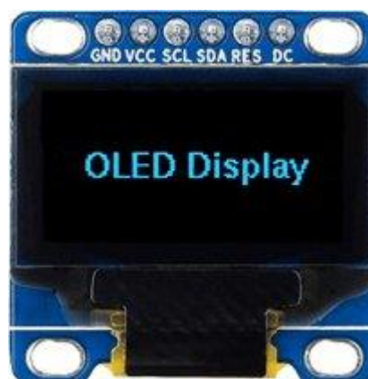
Slika 18: OLED zaslon s SPI komunikacijo
