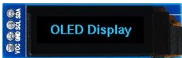
Slika 17: Ležeči OLED zaslon (z I2C komunikacijo)
