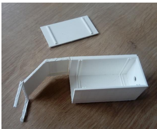
Slika 21: 3D natiskano ohišje pametnih očal
