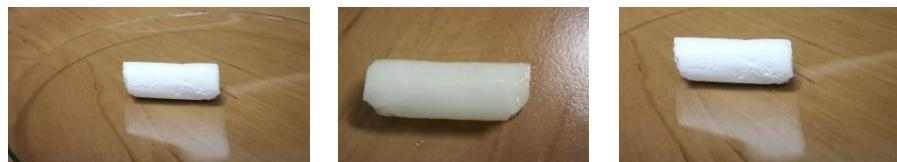
SLIKA 20. Vzorec 1816 pred, med in po absorpciji propan-1-ola
