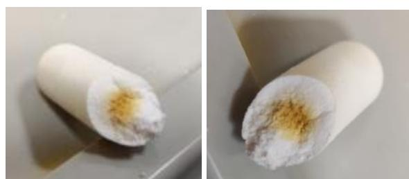
SLIKA 24. Porušenje dendritne strukture aerogela pri temperaturi  $350^{\circ}\text{C}$ .
