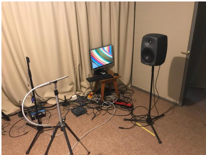
Slika 7: Meritvena postavitev v gluhi sobi
