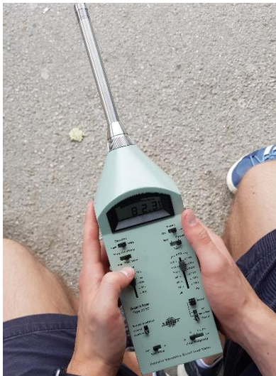
Slika 6: Referenčni merilnik BK2230 fonometer, BK4155 mikrofon, BK4231 kalibrator
