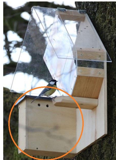
Slika 20: Pametni krmilnik ptic, na katerem je z oražno označena škatla z elektroniko, v kateri se nahaja med drugimi tudi najina merilna naprava.
