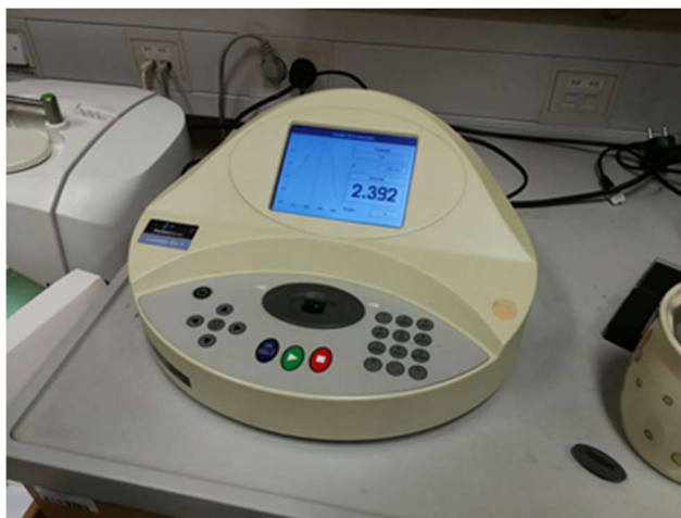
SLIKA 9. UV spektroskopska določitev koncentracije TCS v vzorcih vode
