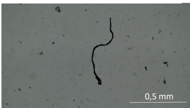
Slika 15: Vlakna najlona, posneta z optičnim mikroskopom
