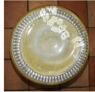
Slika 16: Vodni kamen na dnu steklenice
