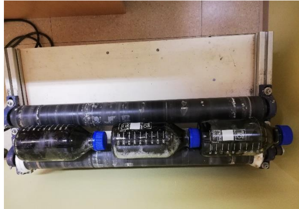
Slika 6: Valja za simulirano pranje, na katerem se vrtijo steklenice
