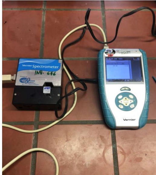
Slika 18: Merjenje absorbance vzorcev v šolskem laboratoriju
