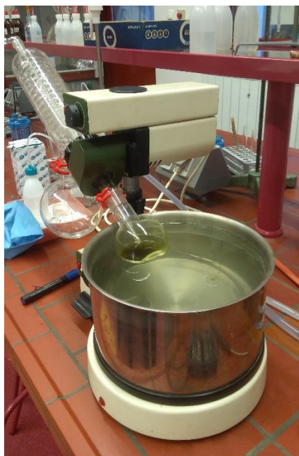
Slika 10: Ločitev z rotavaporjem v šolskem laboratoriju
