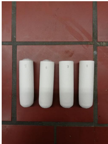
Slika 7: Pripravljene tulci pred izvedbo Soxhlet ekstrakcije
