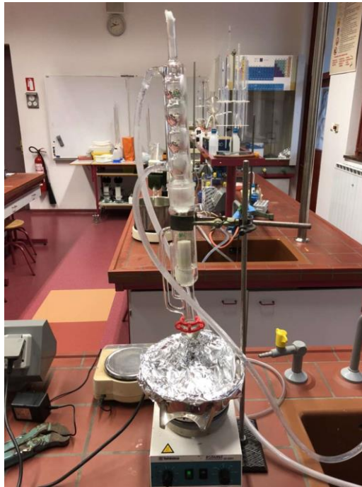
Slika 8: Soxhletov aparat v šolskem laboratoriju
