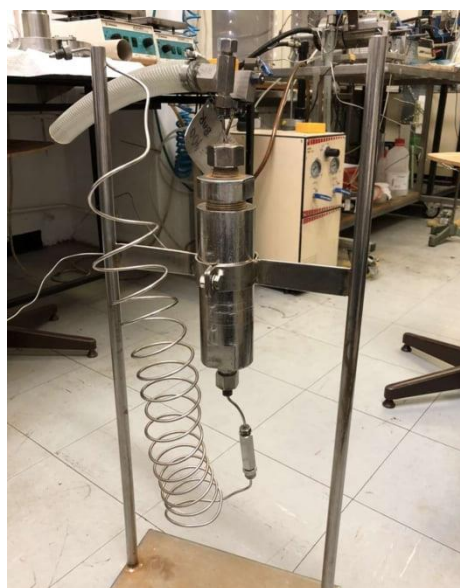
Slika 15: Ekstrakcijski avtoklav, pripravljena za vodno kopel (lasten vir)
