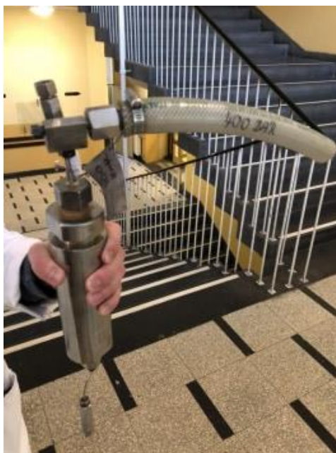
Slika 10: Zatesnjena ekstrakcijska posoda s čilijem (lasten vir)
