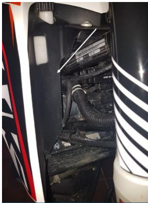
Slika 35: Prikaz nameščenega magnetnega senzorja (lasten vir)
