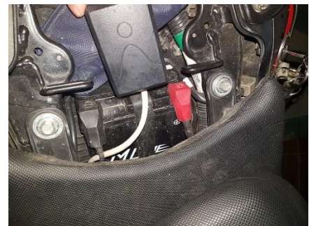
Slika 36: Mikrokrmilnik v vodo tesni škatli, nameščen pod sedežem (lasten vir)
