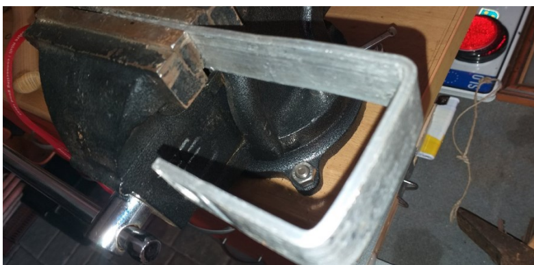
Slika 35: Slika upogibanja držal s pomočjo primeža.
