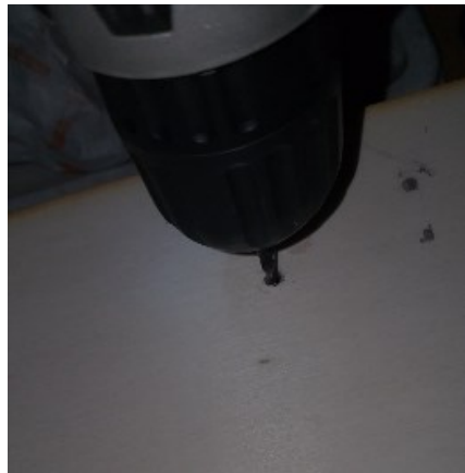
Slika 44: Vrtanje lukenj v prašilček za pritrjevanje na ogrodje vrtička.
