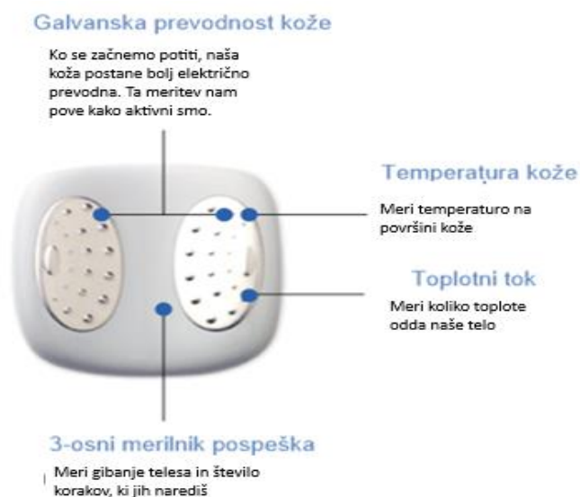
Slika 2 prikazuje hrbtni del naprave in vgrajene senzorje
