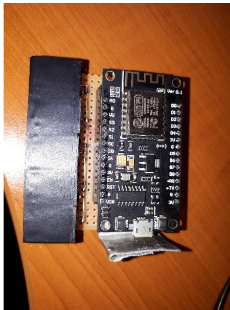
Slika 12 - Plošča krmilnega dela z natičnim krmilnikom NodeMCU
