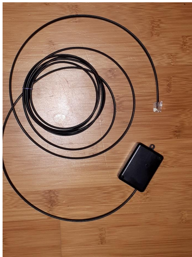
Slika 15 - Senzor v ohišju s priključnim kablom in konektorjem
