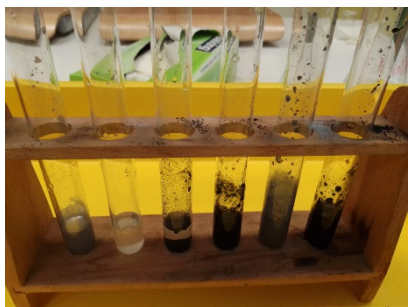
Slika 38: Preverjanje reakcij praškov s kislinami in bazami (Zver, 2020).
