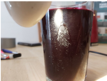
Slika 31: Prstni odtis, ki nastane po dodajanju sekundnega lepila (Zver, 2019).
