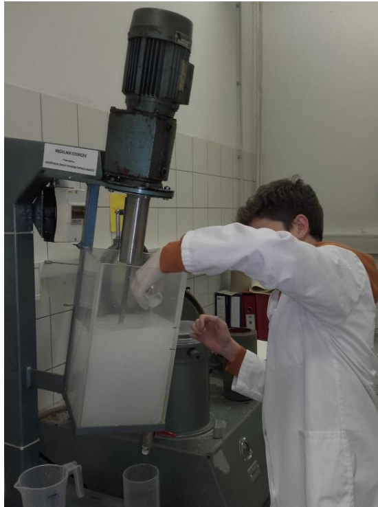
Slika 8: Dodajanje klejiva v celulozno zmes [osebni arhiv]
