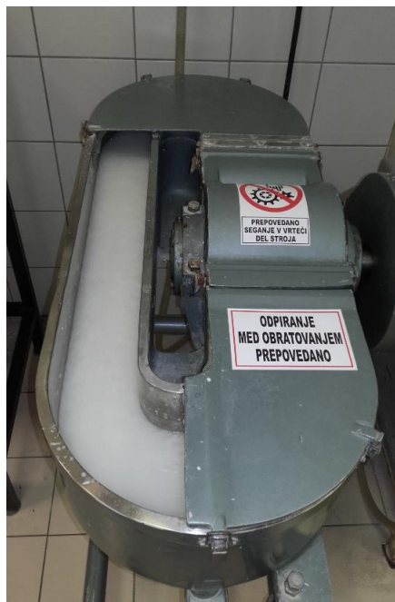
Slika 7: Naprava za mletje in pripravo celulozne kaše po Valleyu [osebni arhiv]
