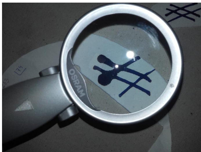
Slika 23: Sled črnila na neklejenem vzorcu [osebni arhiv]
