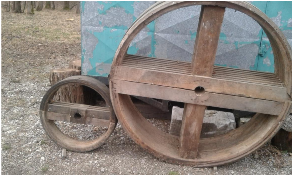
Slika 42: Glavno mlinsko kolo znotraj premer 1,5 m in manjše mlinsko kolo premera 60 cm (Vir: Vlado Balažic)
