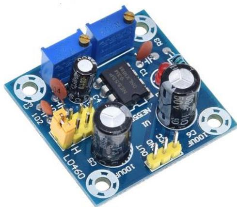
Slika 4: izdelana kit elektronika - generator signala
