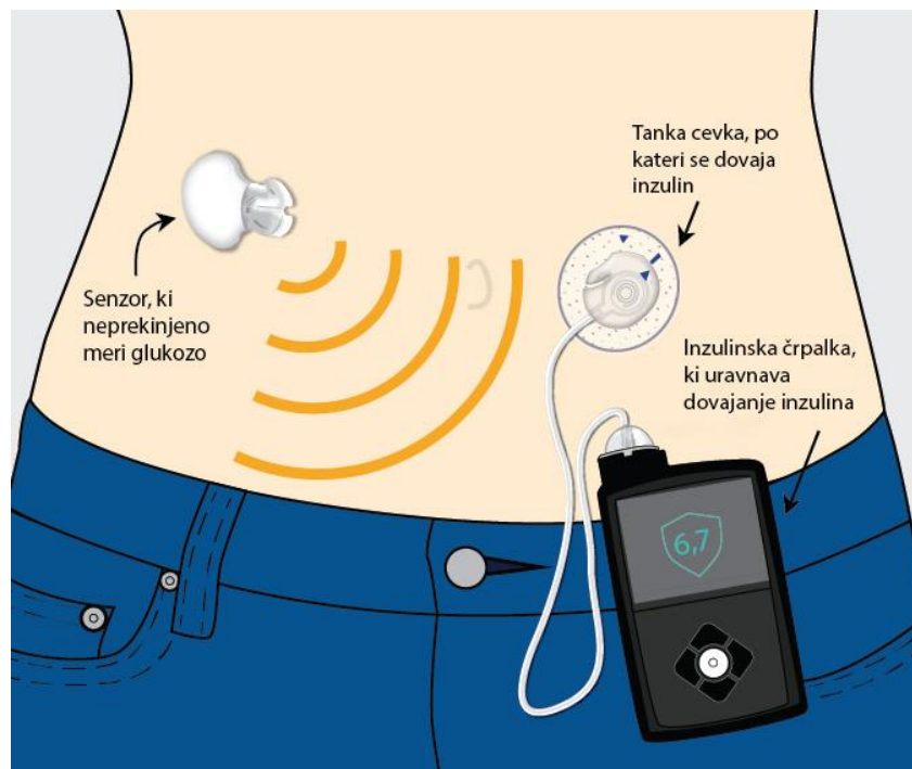
Slika 9: Shematski prikaz nameščenega senzora z inzulinsko črpalko in cevko za dovajanje inzulina v medceličnico [9]
