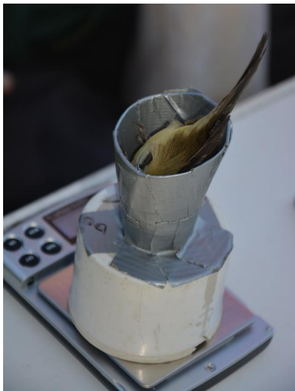
Slika 30 Natančna tehtnica, prilagojena na način, da je možno varno tehtanje ulovljenih ptic.
