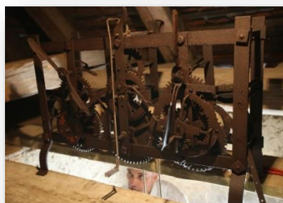
Slika 4 Mehанизem stolpne ure (Maselj, 2016)
