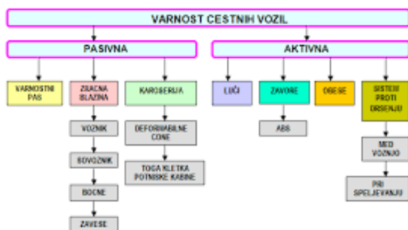
Slika 3: Varnostne naprave v cestnem vozilu.
