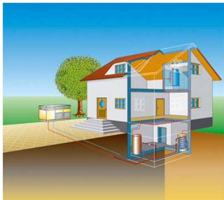
Slika 33: Primer izvedbe topotne črpalke (ZRAK/VODA)
