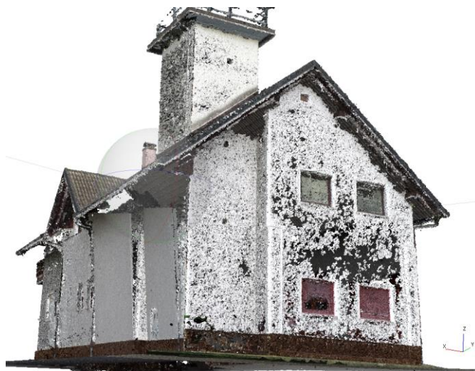
Slika 25: Luknje v oblaku točk iz fotografij
