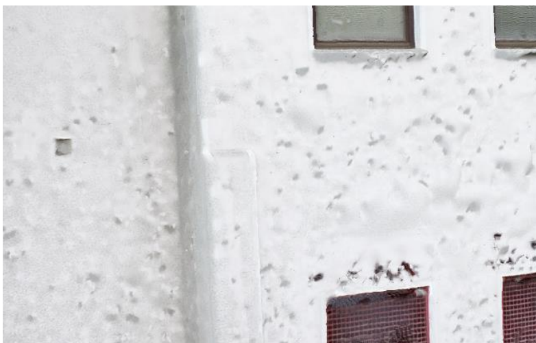
Slika 29: Hrapava površina modela zaradi razpršenosti točk okoli ploskve
