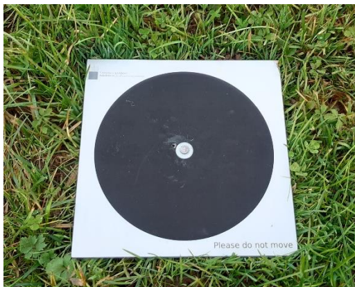
Slika 8: Črno bela tarča za oslonilno točko pri fotografiranju z letalnikom
