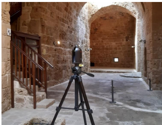
Slika 2: Terestrični laserski skener Leica BLK360 (vir: Tilen Urbančič)
