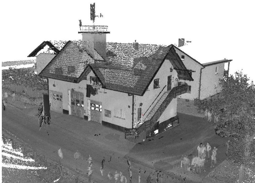
Slika 17: Georeferencirani oblak točk terestričnega laserskega skeniranja pred urejanjem, prikazan z intenzitetami
