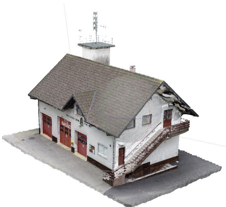
Slika 26: 3D-model objekta iz aerofotogrametričnega zajema z letalnikom
