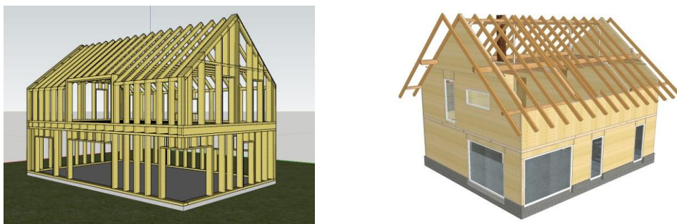
Slika 2: Skeletna 3* in masivna 4* gradnja
