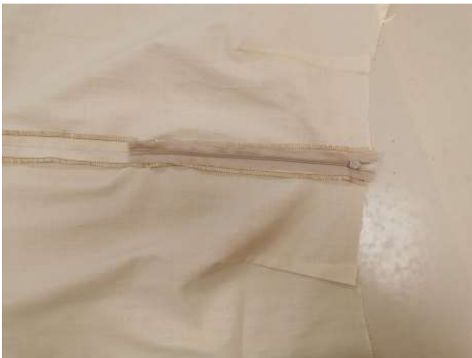
Slika 52: Všita zadrga na zadnjem delu krila
