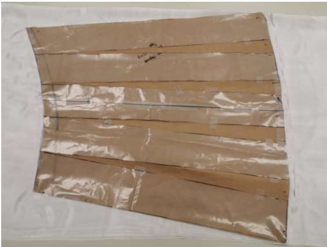
Slika 45: Krojenje spodnjega dela krila na tkanino
