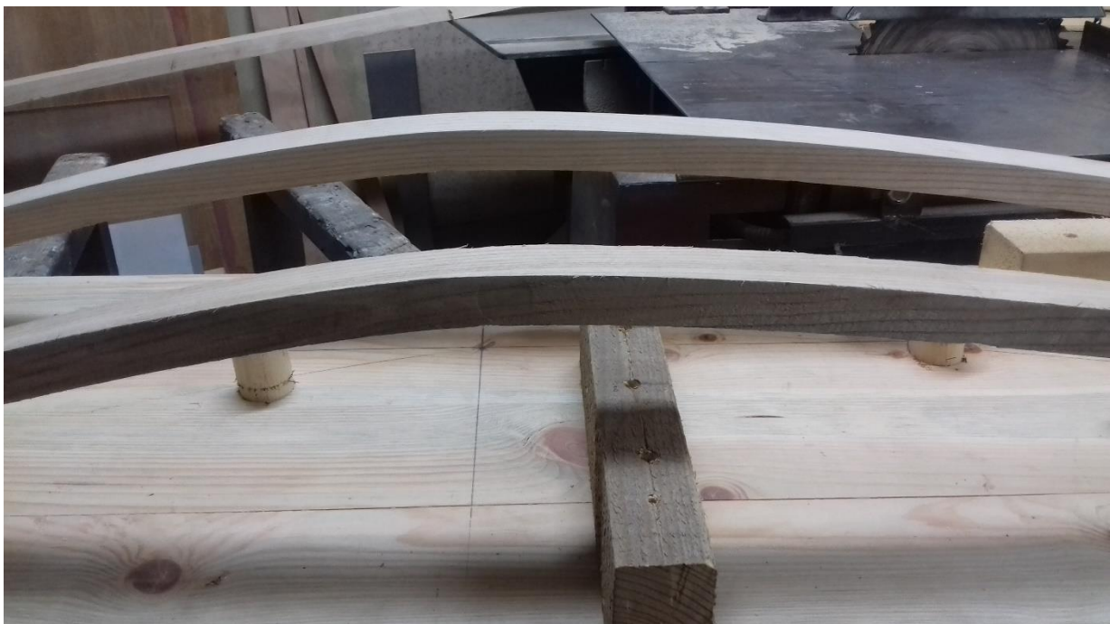
Slika 37: Prikaz rezultata mokrega krivljenja (vir: lasten)
