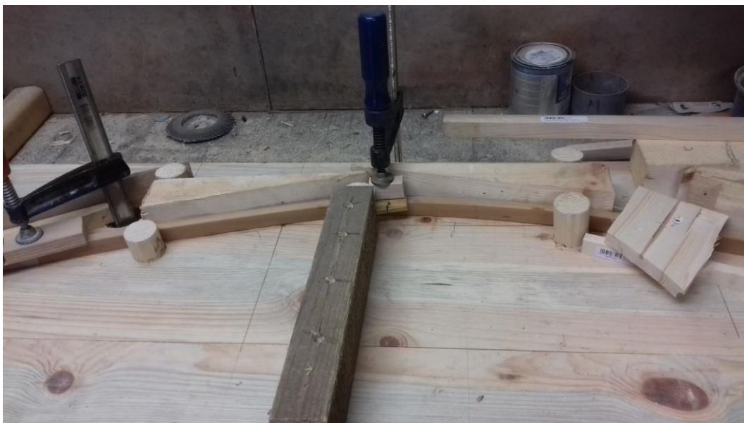
Slika 13: Postavitev lesa (bukve) v šablono (vir: lasten)
