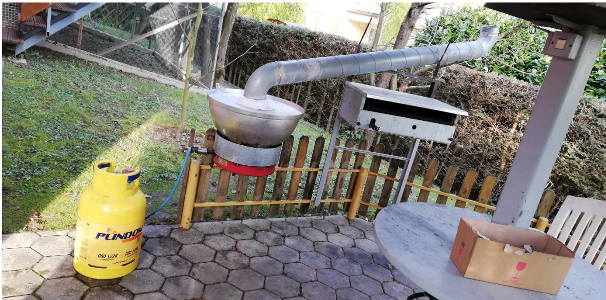
Slika 16: Doma narejena "komora" za parjenje lesa (vir: lasten)
