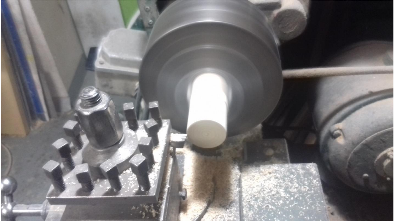
Slika 6: Izdelava čepov za zagostitev lesa na šabloni (vir: lasten)
