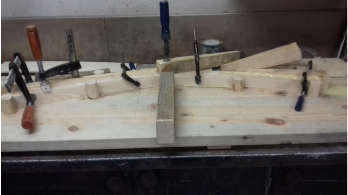
Slika 32: Stiskanje in fiksiranje obdelovanca v šablono (vir: lasten)
