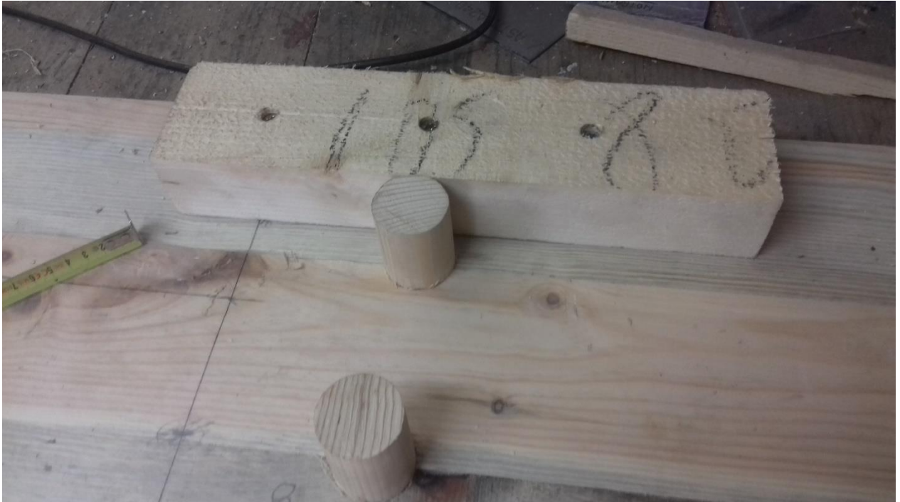
Slika 8: Dodatna opora za čepe in točka za lažje pritrdjevanja lesa v šablono (vir: lasten)
