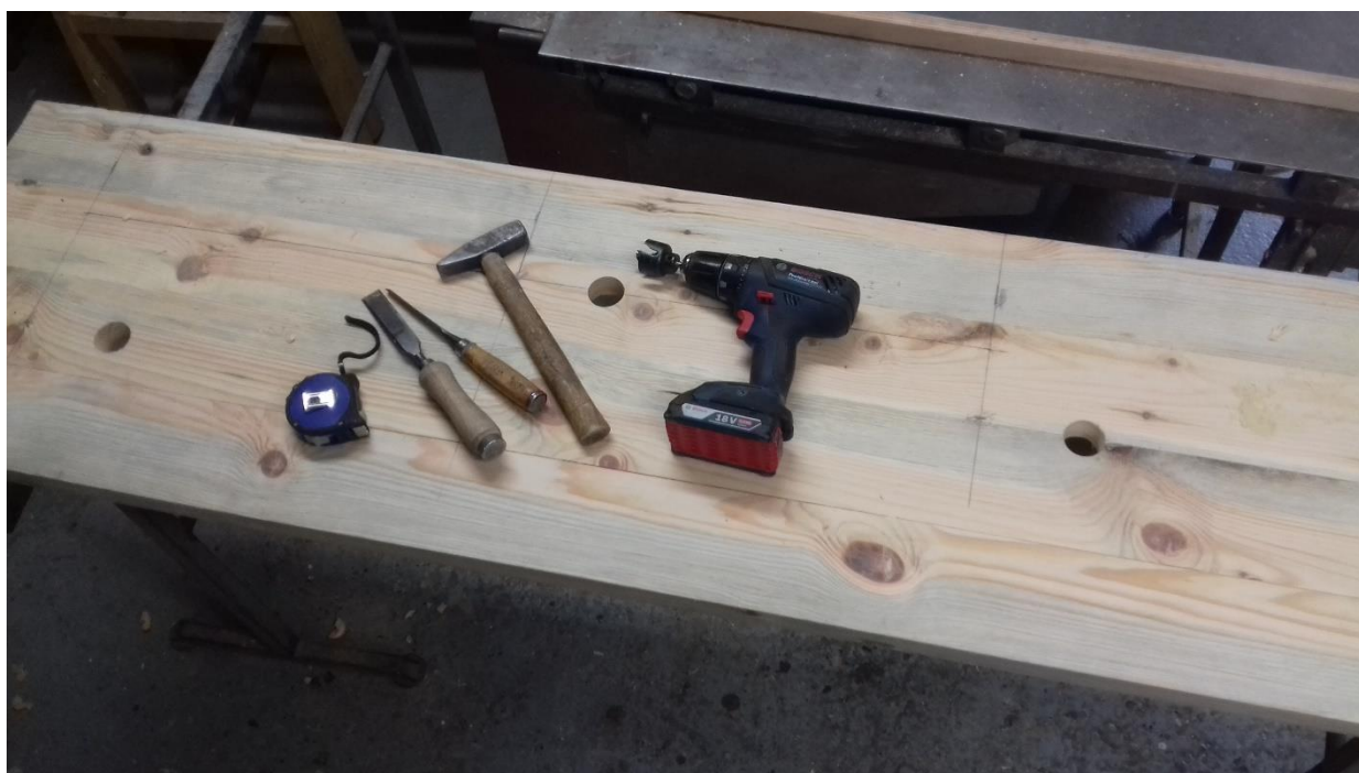
Slika 5: Merjenje, risanje in vrtanje lukenj za čepe (vir: lasten)
