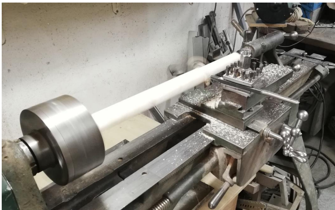
Slika 39: Izdelava veznikov nog (vir: lasten)
