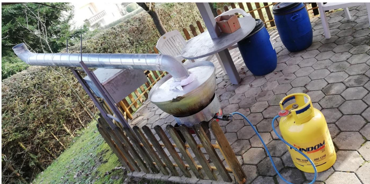
Slika 17: Doma narejena "komora" za parjenje lesa iz druge perspektive (vir: lasten)
