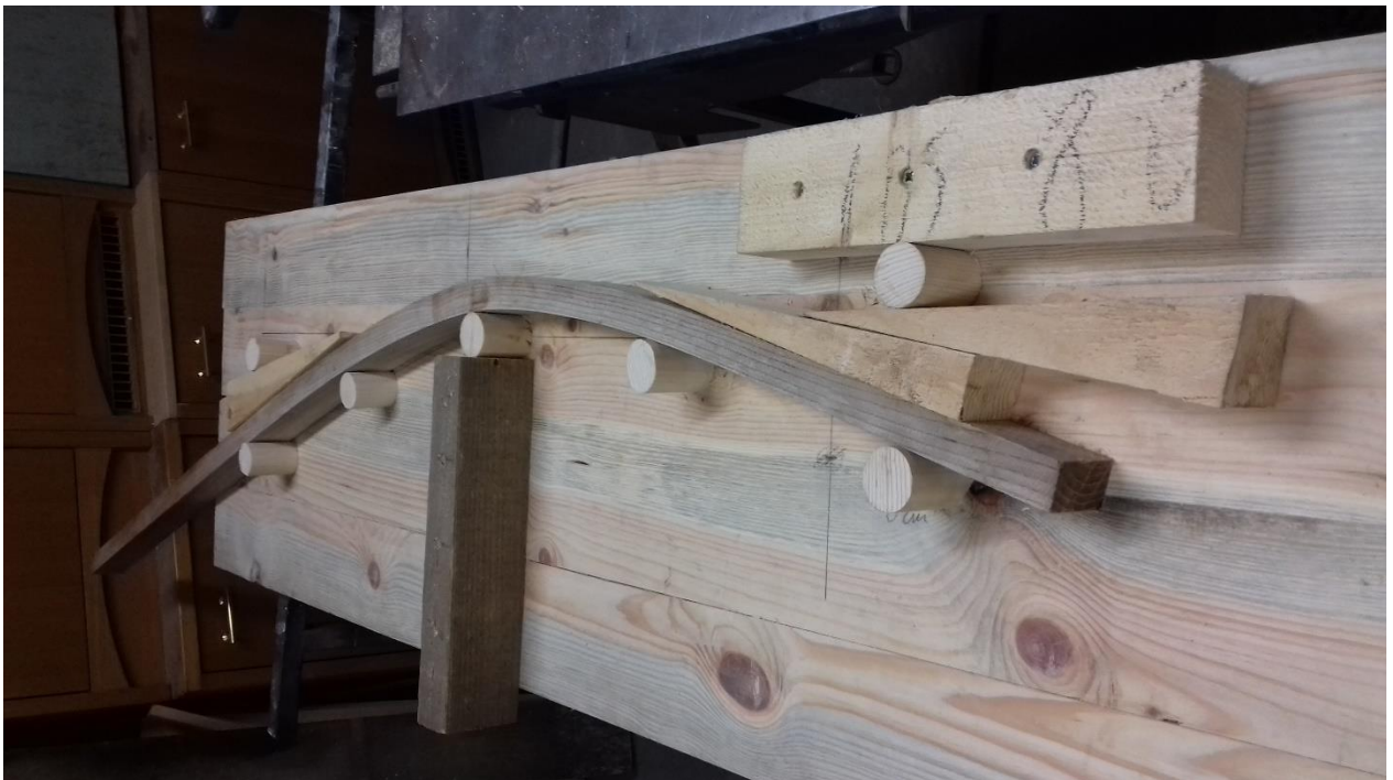
Slika 9: Prikaz vstavljanja in zagozdenja lesa v šablono (vir: lasten)
