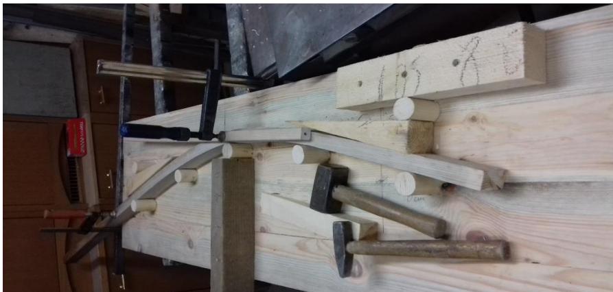
Slika 19: Poskus hladnega krivljenja jesena, ki je že nameščen v šabloni (vir: lasten)
