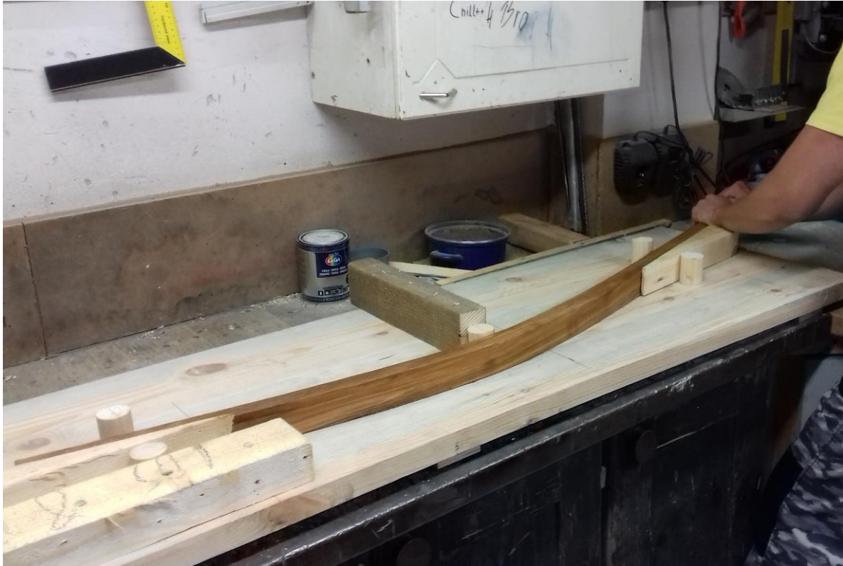
Slika 29: Vstavljanje jesena v šablono (vir: lasten)
