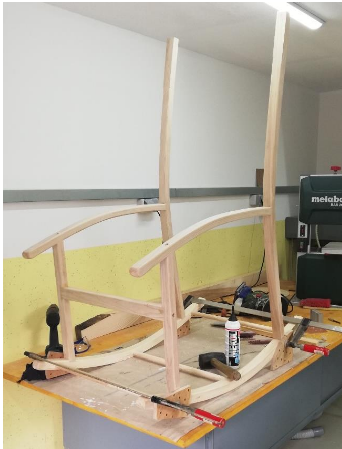
Slika 43: Lepljenje gugalnika (vir: lasten)
