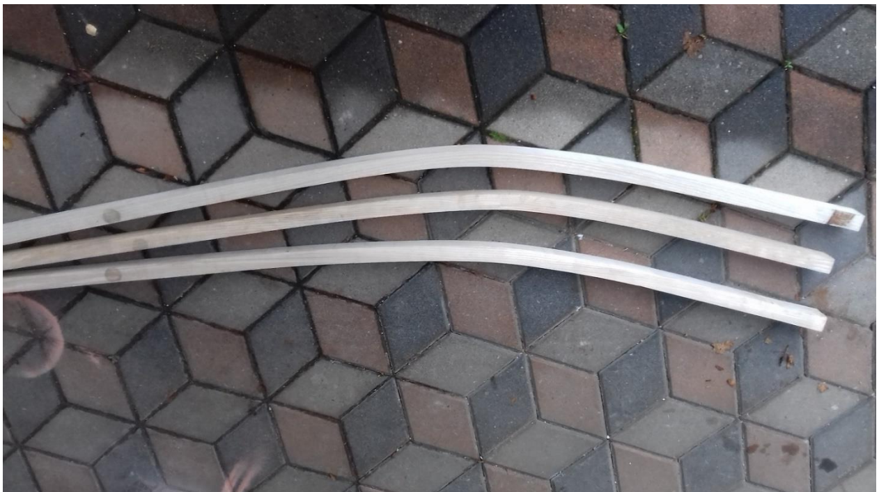
Slika 34: Trije različni kosi jesena, ki so krivljeni na tri različne načine (vir: lasten)
