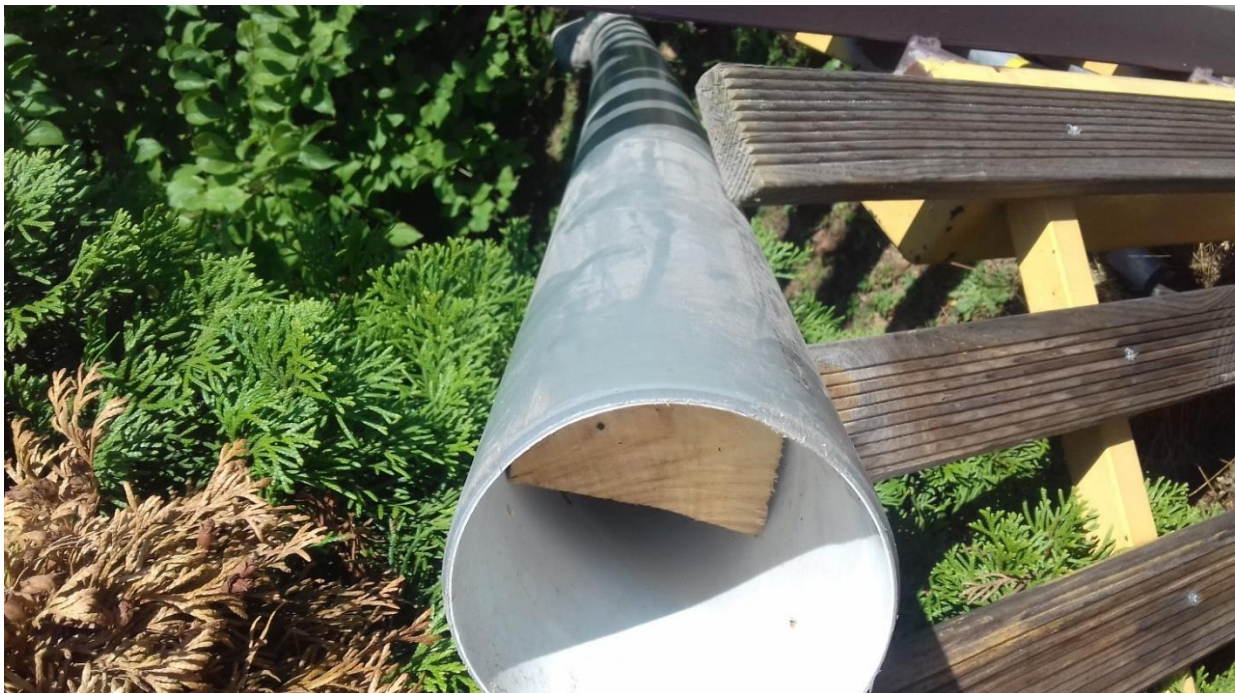
Slika 18: Les, ki se namaka v cevi, napoljnjeni z vodo (vir: lasten)
