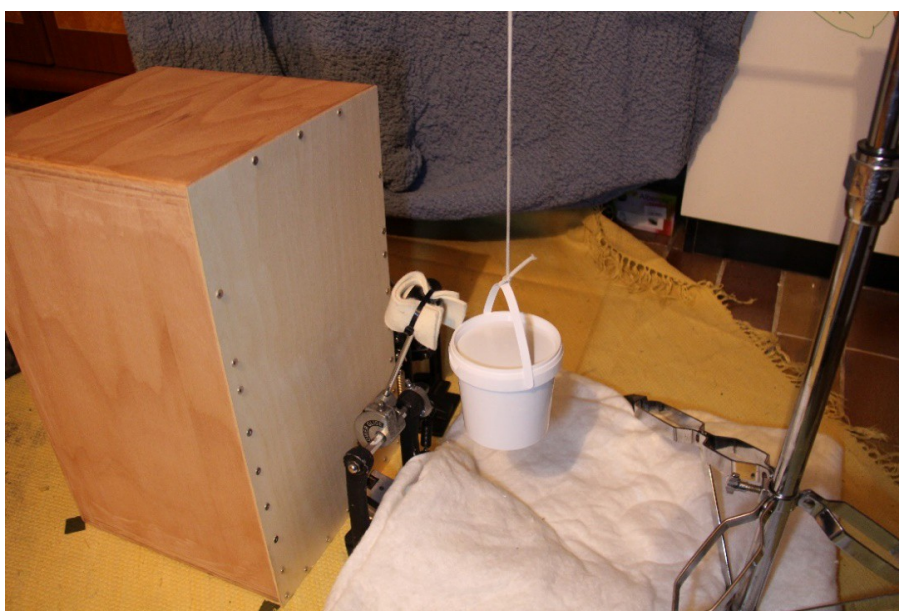
Slika 7: Udarjanje na cajon s pomočjo pedala in uteži. (Slikovni viri: Slika 6).
