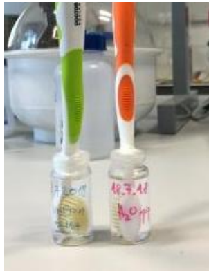
Slika 20: Zobna ščetka v umetni slini (levo) in vodovodni vodi (desno)
