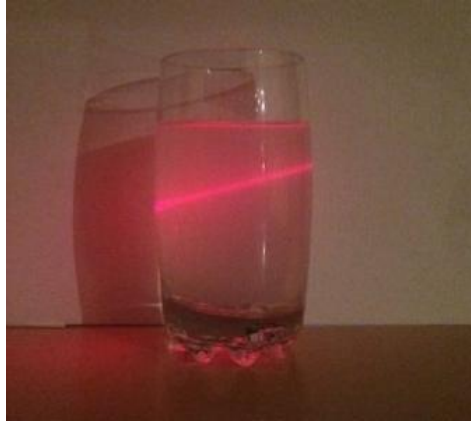
Slika 3: Primer koloidnega sistema iz narave (mleko, razredčeno z vodo) in vidna pot žarka
