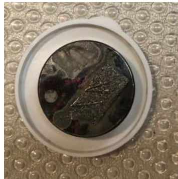
Slika 24: Nosilec z vzorci dentalnih produktov
