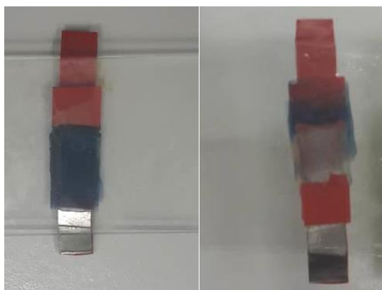
Slika 10 in 11 : Sestavljena celica ob prvem priključku na pozitiven vir električne napetosti in sestavljena celica po drugem priključku na negativen vir električne napetosti.
