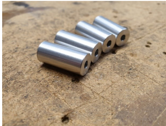
Slika 9: Distančniki med osovino in zgornjo ploščo
