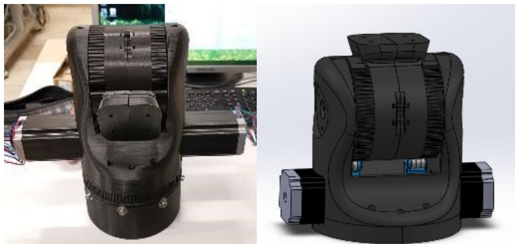
*Slika 13: Druga os robotske roke*
