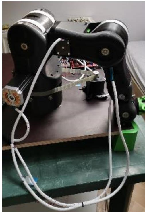
*Slika 37: Celoten robot z zaščitenimi kabli*
