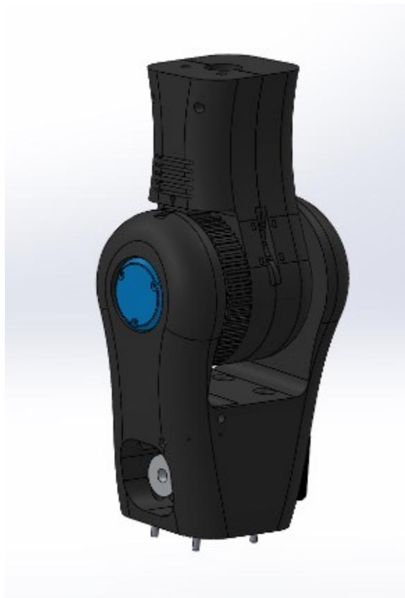
*Slika 14: Tretja os robotske roke*
