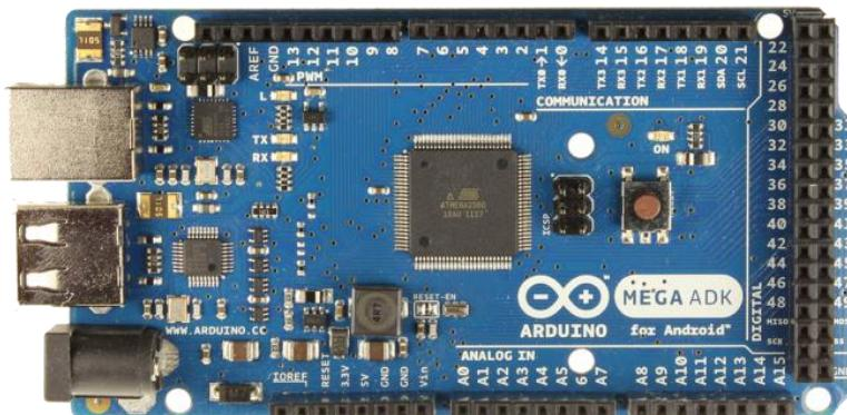
Slika 1: Razvojna plošča Arduino Mega (vir: <https://bit.ly/2Qc8QZw>)
