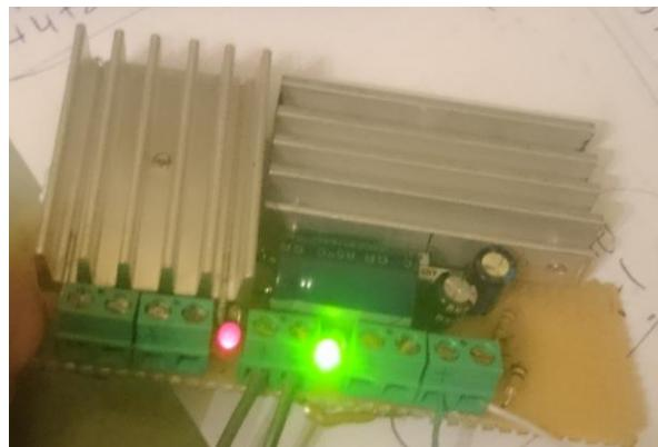
Slika 16: Nedokončan PSU Modul(vir: Avtor naloge)
