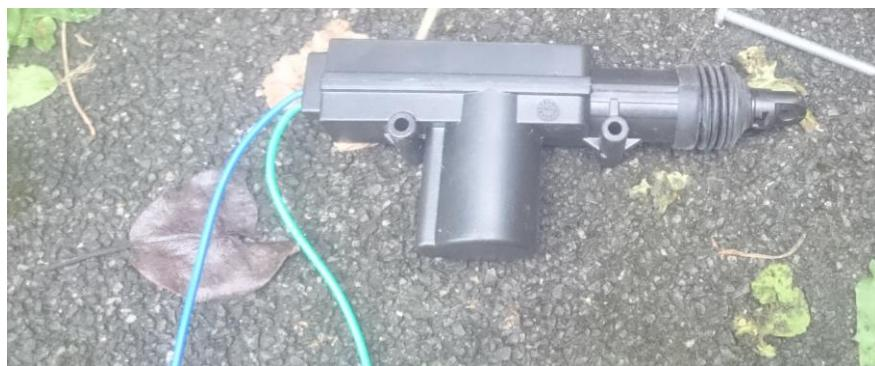
Slika 30: Aktuator(vir: Avtor naloge)
