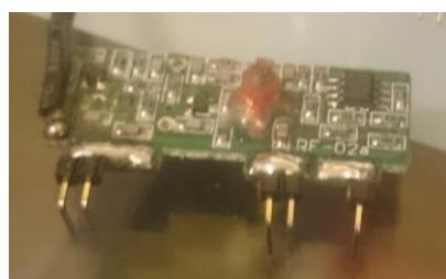
Slika 22: RF Modul RF-02A (vir: Avtor naloge)
