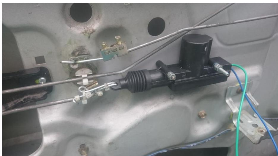
Slika 31: Testna Vgradnja v leva vrata(vir: Avtor naloge)
