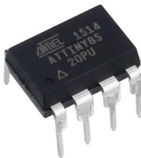
Slika 2: Attiny85 (20PU) V DIP8 Ohišju(Vir: shorturl.at/kvwx3)
