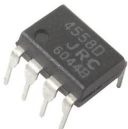
Slika 23: Operacijski ojačevalnik
