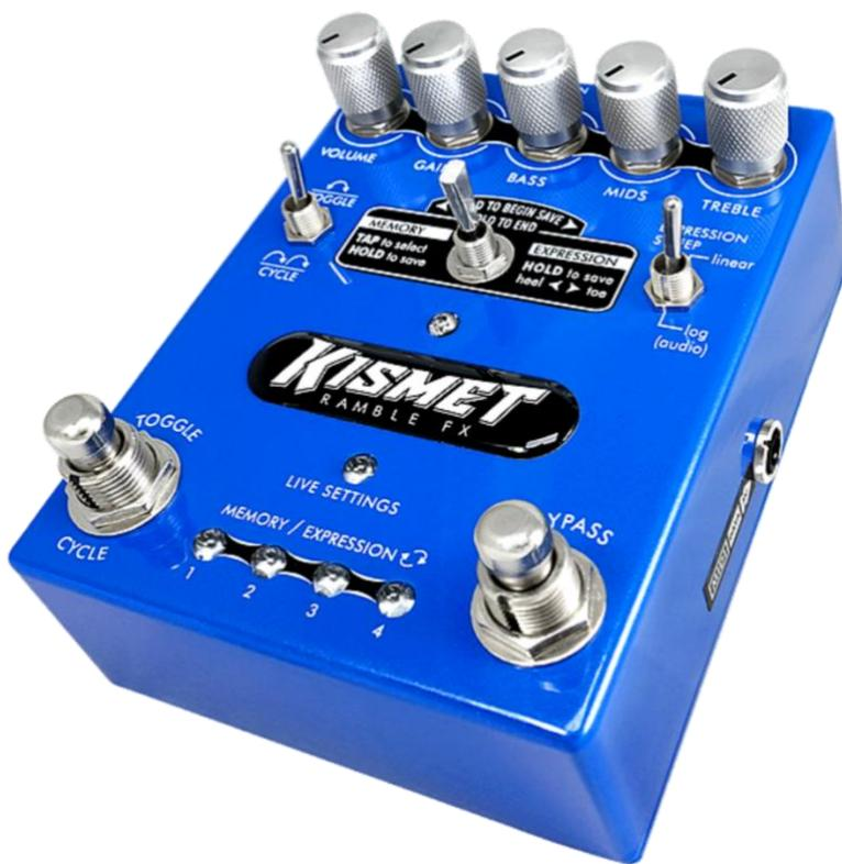
Slika 5: Analogni efekt z digitalnim upravljanjem
