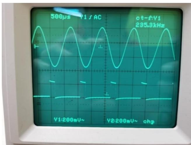
Slika 28: Izhodni signal je močno porezan ("Hardclipping")
