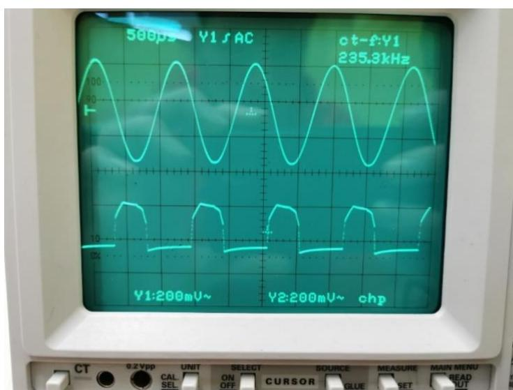
**Slika 27:** Izhodni signal je rahlo porezan ("softclipping")
