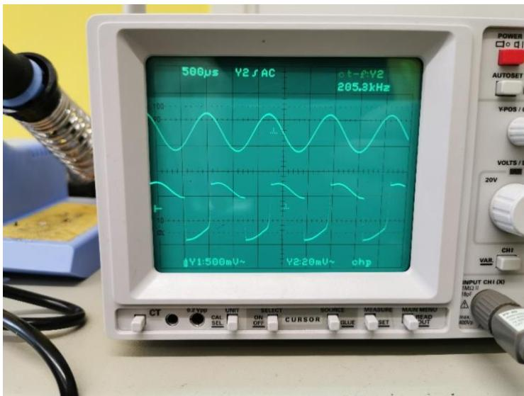
**Slika 14:** Primerjanje vhodnega in izhodnega signala z osciloskopom 2
