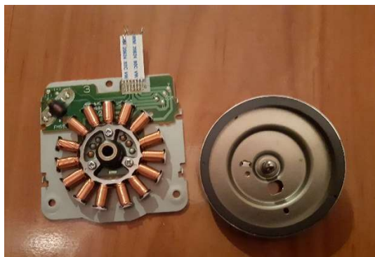
Slika 4: Koračni motor pogona 1,4" gibkega diska
