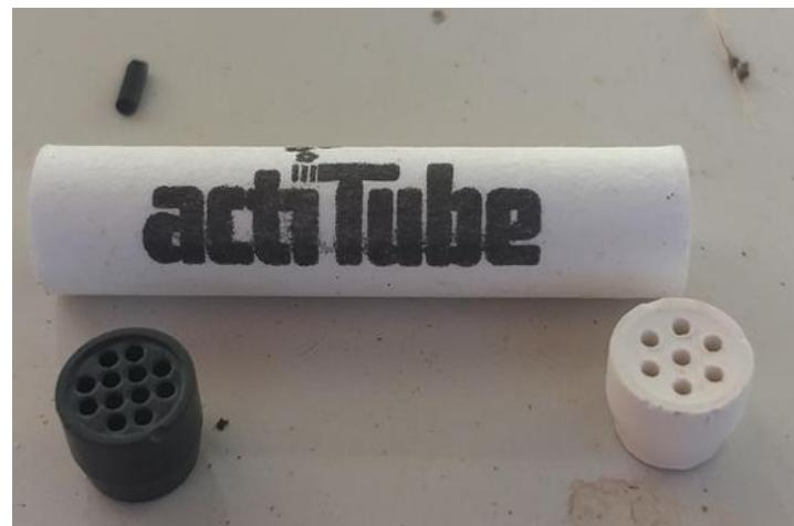
*Slika 7: Acti Tube filter s keramičnim (belim) in plastičnim (črnim) delom*
