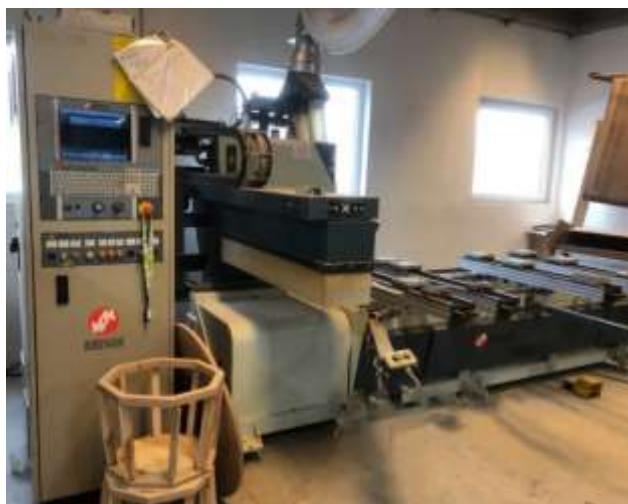
Slika 66: CNC stroj in izrez prvih delov iz vezane plošče
