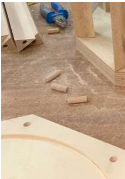
Slika 70: Pripravljene trikotne noge in osmkočni segment za sestavljanje
