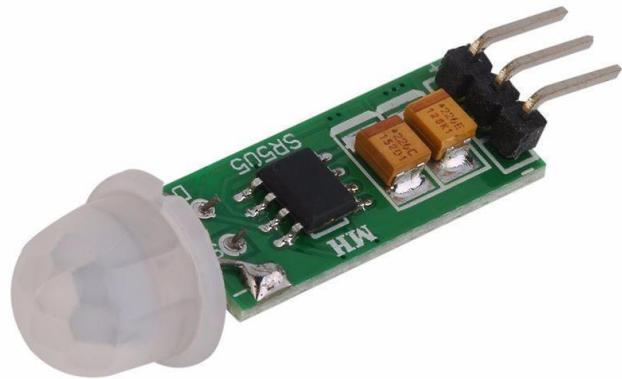
Slika 3: PIR senzor (vir: canadarobotix.com)
