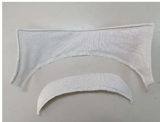
Slika 19: Notranja spodnji in zgornji del kape z izdelanim tunelom in žičnim ogrodjem. (Vir: lasten vir)
