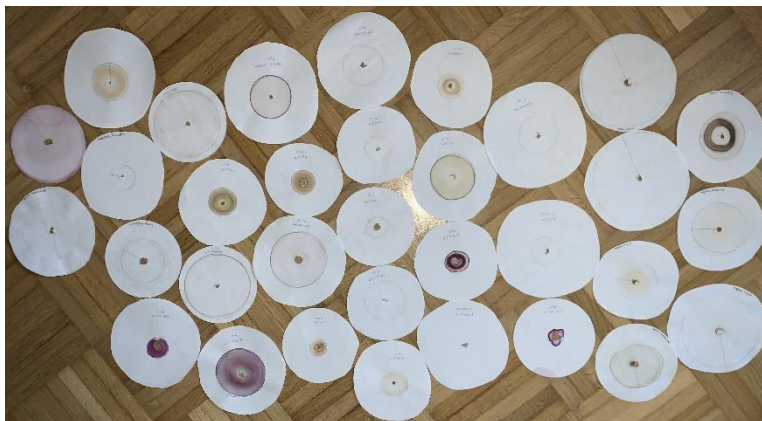
Slika 12: Merjenje polmerov vidnega barvila na kromatogramih
